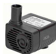
Vattenstenspump Mikro AQ 300 12 V Till vattenstenar max 20 cm höga. Med & utan lampa. Behöver 3 cm vattendjup.
